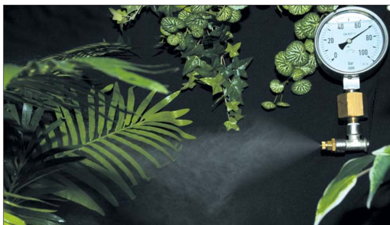
Ugello O5AP foro 0,2 mm, alla pressione di esercizio di 70 bar. O5-AP Spray nozzle hole 0,2 mm - pressure 70 bar
